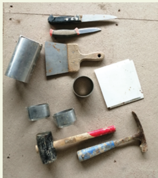
Figure 39 : Anneaux, poussoir, couteau à enduire, couteaux, massette, marteau et plaque
