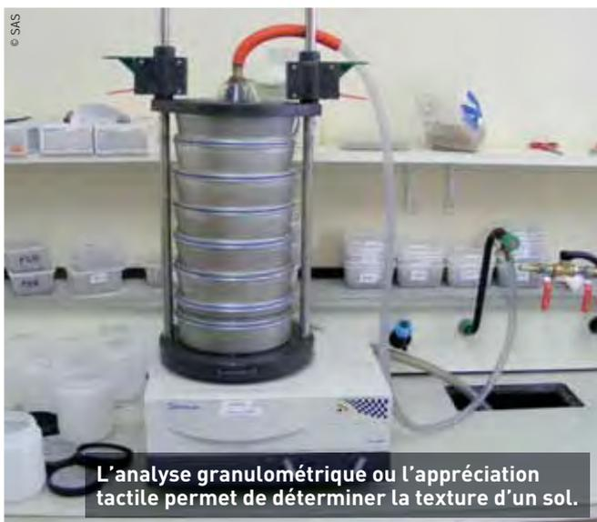
L'analyse granulométrique ou l'appréciation tactile permet de déterminer la texture d'un sol.
