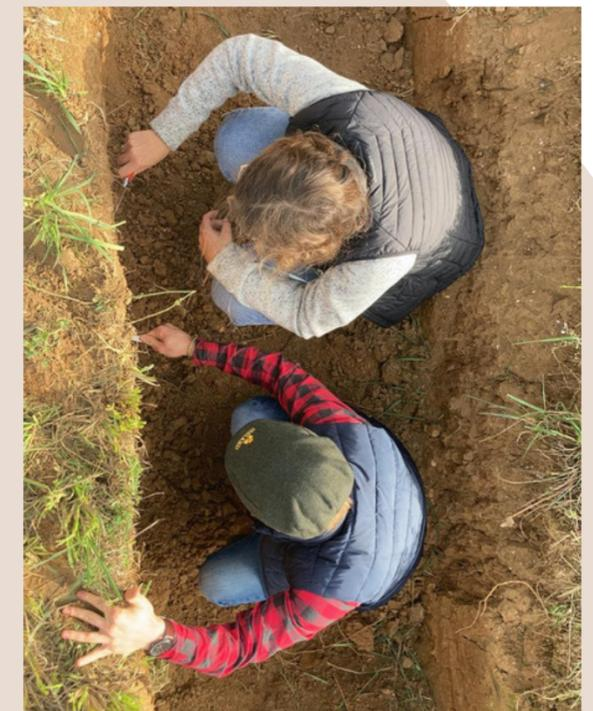
Mesure de la masse volumique apparente de la terre fine, des pourcentages volumique et massique de la terre fine et des éléments grossiers dans un sol caillouteux.
