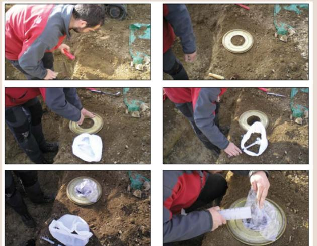
Mesure de la masse volumique apparente de la terre fine, des pourcentages volumique et massique de la terre fine et des éléments grossiers dans un sol caillouteux.
