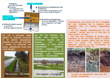
Schéma 3 : évacuation et stockage de l'eau des sols
